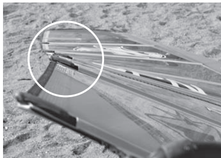
陸上でセイルを見た場合、ブームエンドすぐ上のリーチに張りがあることが判る。目安となるのはバテン。丸で囲んだ部分にルーズさがないように、繊細にアウトホールのテンションを調節してやろう。時にはテンションに強弱を付けて試し乗りをしてみた方がいい。
